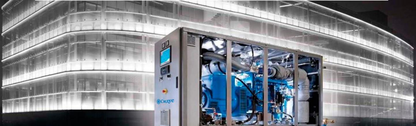
Наши ТЭЦ – это компактные когенерационные установки с высокоэффективной утилизацией тепла из воды рубашки и выхлопных газов газового двигателя. Инновационная конструкция обеспечивает простую и компактную установку. Все основные компоненты, такие как генераторный блок газового двигателя, теплообменники, циркуляционные насосы, первичный глушитель выхлопных газов и шкаф управления, монтируются на заводе на общей раме.
